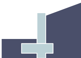
muro en voladizo
