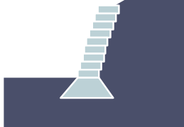
muro de gravedad
